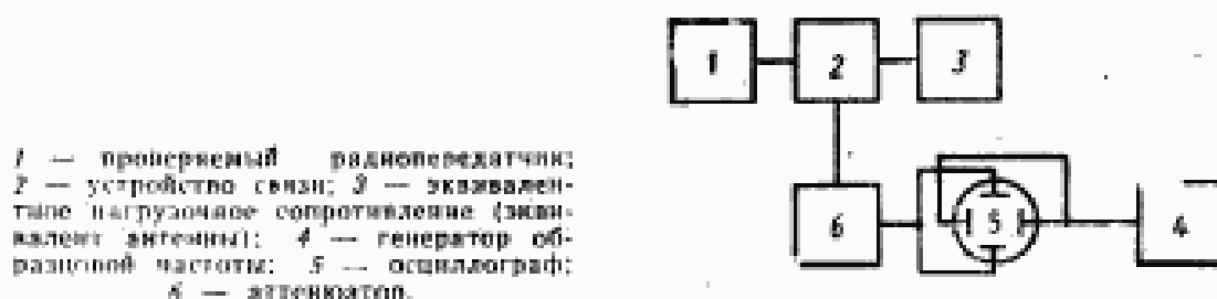
Рисунок 3 — Структурная схема измерения частоты радиопередатчика с применением осциллографического способа
