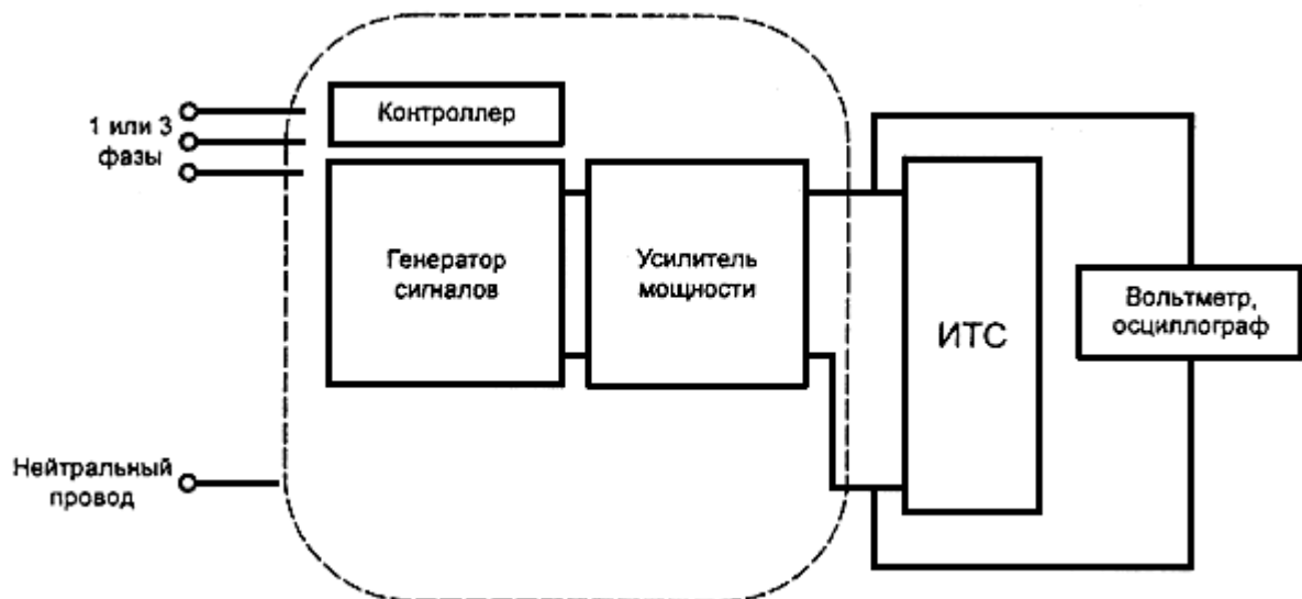
Рисунок 3 - Схема испытательного оборудования с усилителем мощности
