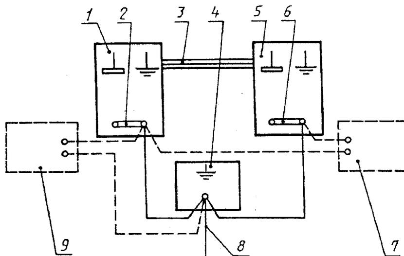
1 - первая стойка испытываемого ТС АС-ЯРО; 2, 6 - перемычки между сигнальной и защитной системами заземления в стойке; 3 - линии связи между стойками; 4 - опорный узел заземления ТС АС-ЯРО; 5 - n-я стойка испытываемого ТС АС-ЯРО; 7 - подключение ИГ к зажимам защитного заземления двух стоек; 8 - цепь связи с физической землей; 9 - подключение ИГ к зажиму защитного заземления стойки и к опорному узлу заземления
