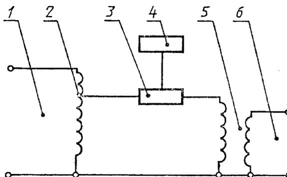
1 - к сети питания переменного тока; 2- автотрансформатор; 3 - коммутатор; 4 - блок управления; 5 - понижающий трансформатор; 6 - к испытуемой цепи ТС АС-ЯРО
