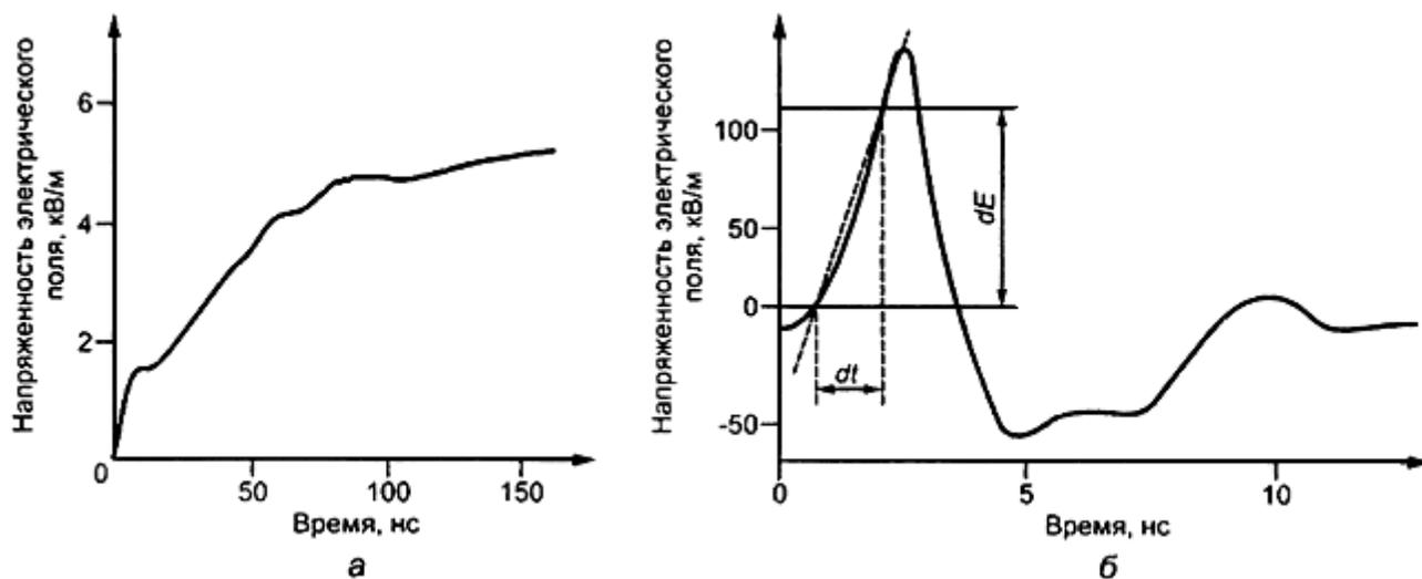
Рисунок В.1 - Типичные формы излучаемых импульсных полей
