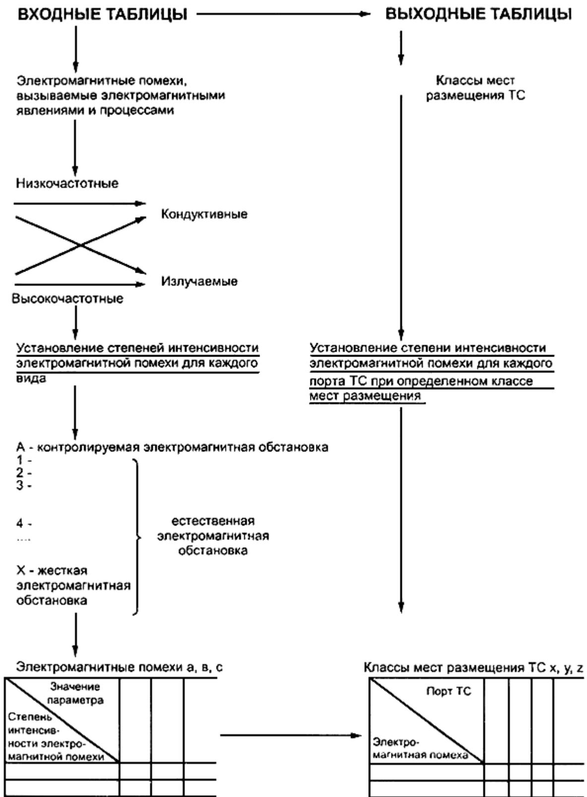
Рисунок 1 - Принцип классификации электромагнитной обстановки
