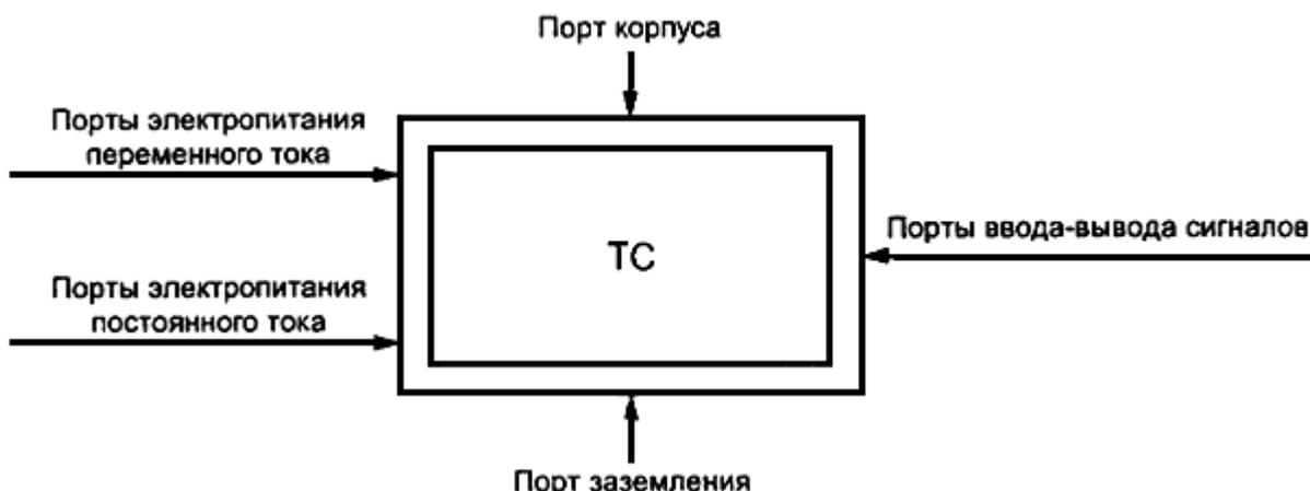
Рисунок 2 - Воздействие электромагнитных помех на порты ТС
