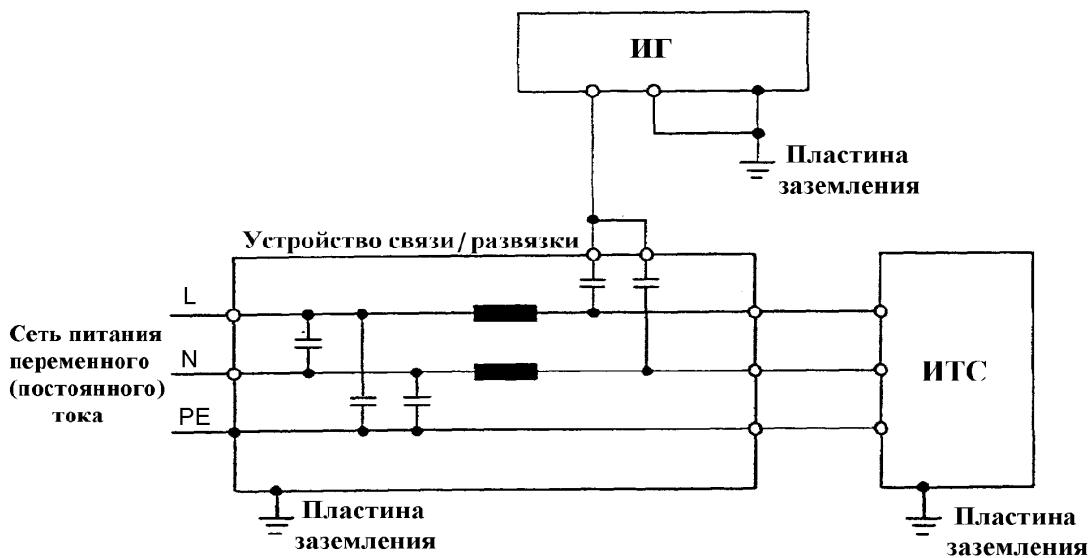
L - фазный провод; N - нейтральный провод; PE – защитное заземление
