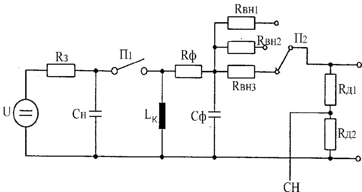
$U$  - источник высокого напряжения;  $R_3$  - зарядный резистор;  $C_n$  - накопительный конденсатор;  $\Pi_1$  - высоковольтный ключ;  $L_k$  - индуктивность колебательного контура;  $R_\phi$  - резистор фильтра;  $C_\phi$  - конденсатор фильтра;  $R_{\text{вн}1}$  - резистор 12 Ом;  $R_{\text{вн}2}$  - резистор 30 Ом;  $R_{\text{вн}3}$  - резистор 200 Ом;  $\Pi_2$  - селектор выходного сопротивления;  $R_{d1}$ ,  $R_{d2}$  - резисторы делителя напряжения;  $CH$  - сигнал для наблюдения
