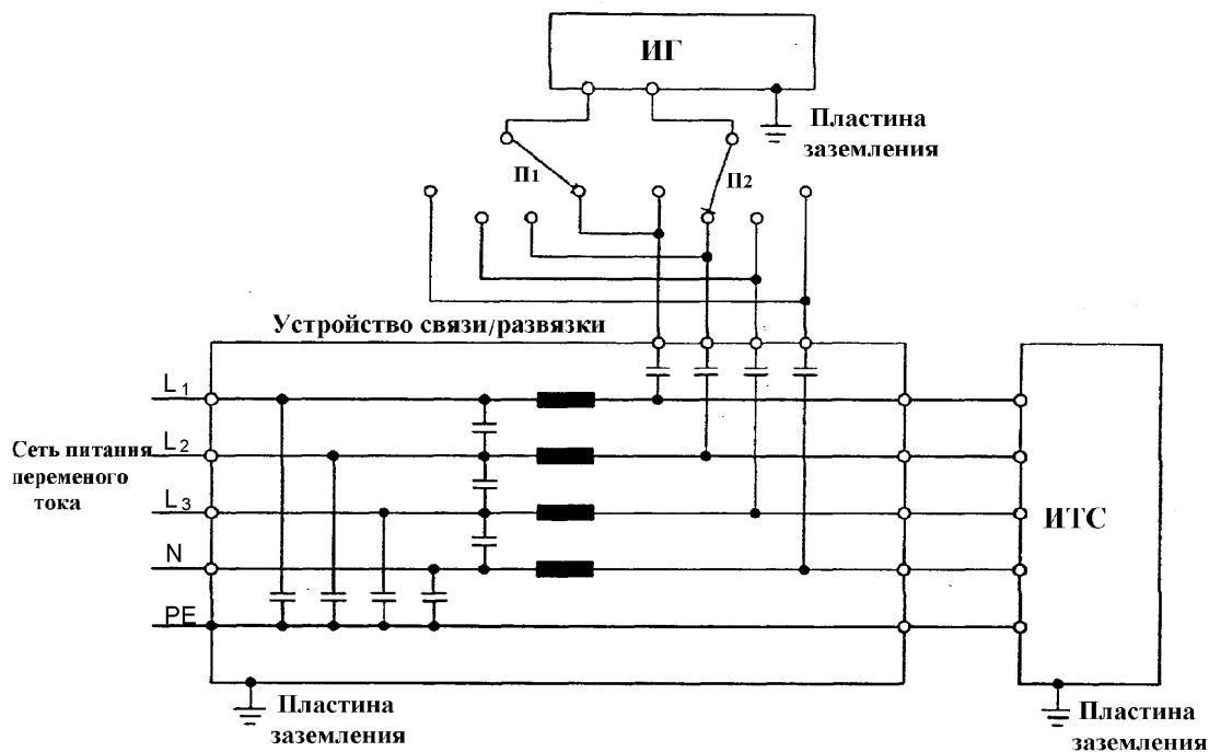
Рисунок 12а - Схема рабочего места с пластиной заземления (см. 7.1.1)
