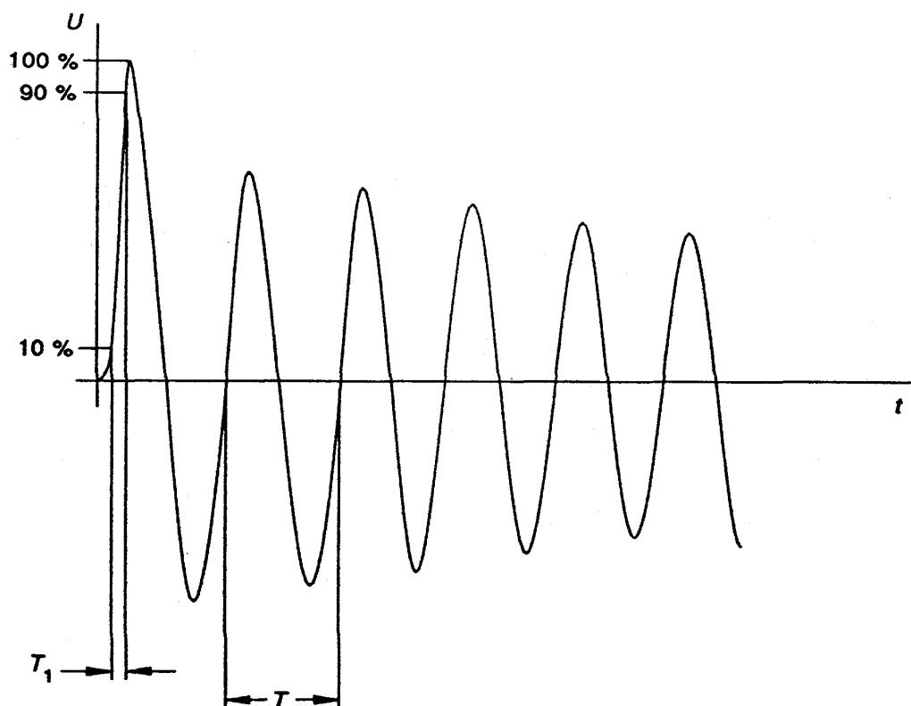
$\tau_1$  – время нарастания напряжения (75 нс);  $T$  - период колебаний (10 мкс для частоты 0,1 МГц, 1 мкс для частоты 1 МГц )
