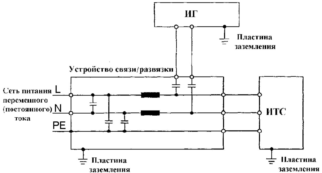
Рисунок 11а - Схема рабочего места с пластиной заземления (см. 7.1.1)
