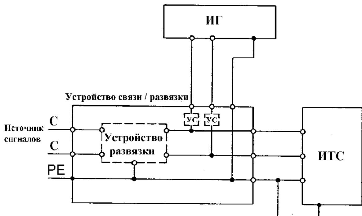
Рисунок 13 б – Схема рабочего места с проводниками заземления (см.7.1.2)
