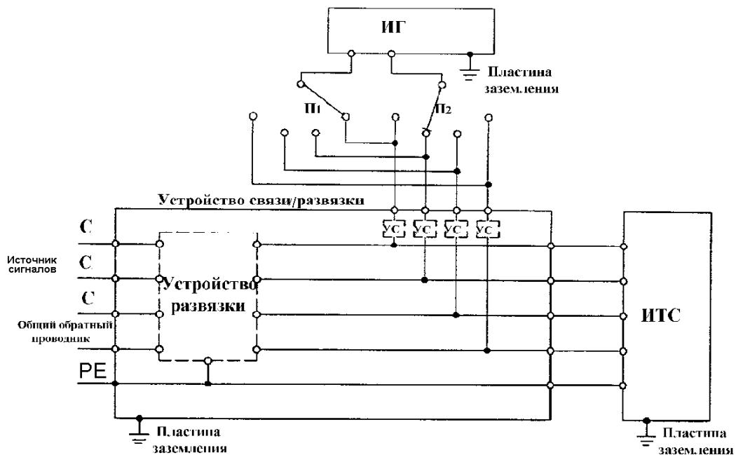
Рисунок 14а - Схема рабочего места с пластиной заземления (см. 7.1.1)
