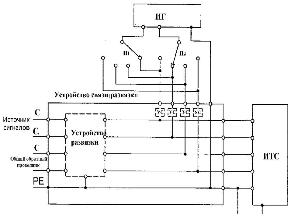
Рисунок 14 б –Схема рабочего места с проводниками заземления (см.7.1.2)
