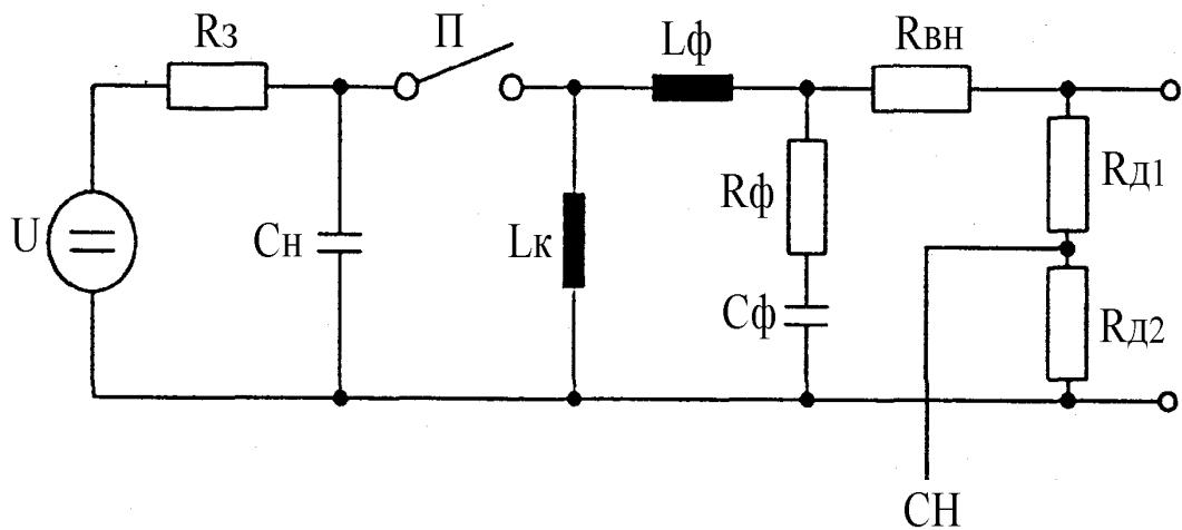
$U$  - источник высокого напряжения;  $R_3$  - зарядный резистор;  $C_H$  - накопительный конденсатор;  $\Pi$  - высоковольтный ключ;  $L_K$  - индуктивность колебательного контура;  $L_\phi$  - индуктивность фильтра;  $R_\phi$  - резистор фильтра;  $C_\phi$  - конденсатор фильтра;  $R_{\text{вн}}$  - резистор выходного сопротивления;  $R_{\text{д}1}, R_{\text{д}2}$  - резисторы делителя напряжения;  $CH$  - сигнал для наблюдения
