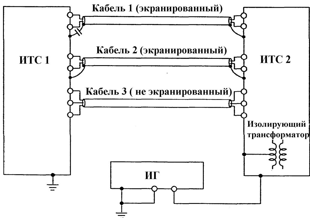
Рисунок 16 - Испытания систем, имеющих порты линий связи с широкополосными сигналами (выход ИГ КЗП заземлен)
