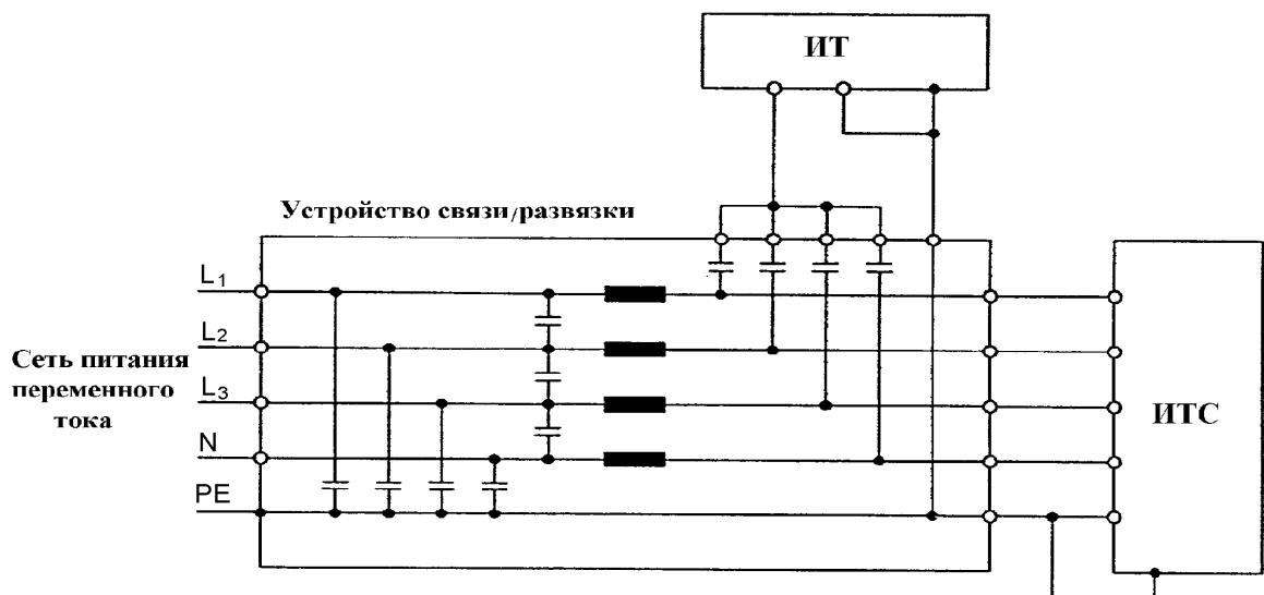
Рисунок 8.в – Схема рабочего места с проводниками заземления (см.7.1.2)
