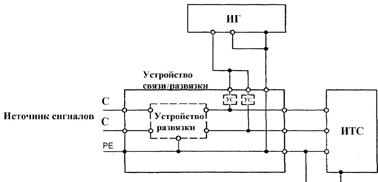
Рисунок 9 - Испытания при воздействии на порт ввода - вывода [одна линия управления (сигнализации), подача помехи по схеме “провод-земля”]
