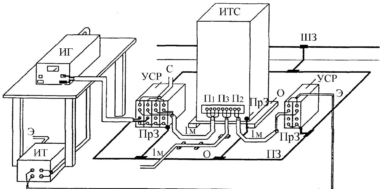
ШЗ - шина защитного заземления; Э - к сети электропитания; П<sub>1</sub> - порт ввода/вывода; П<sub>2</sub> - порт электропитания; П<sub>3</sub> - порт связи; С - к источнику сигналов; ПрЗ - проводник заземления; ПЗ - пластина заземления; УСР - устройство связи/развязки; О - изоляционная опора; ИТ - изолирующий трансформатор
