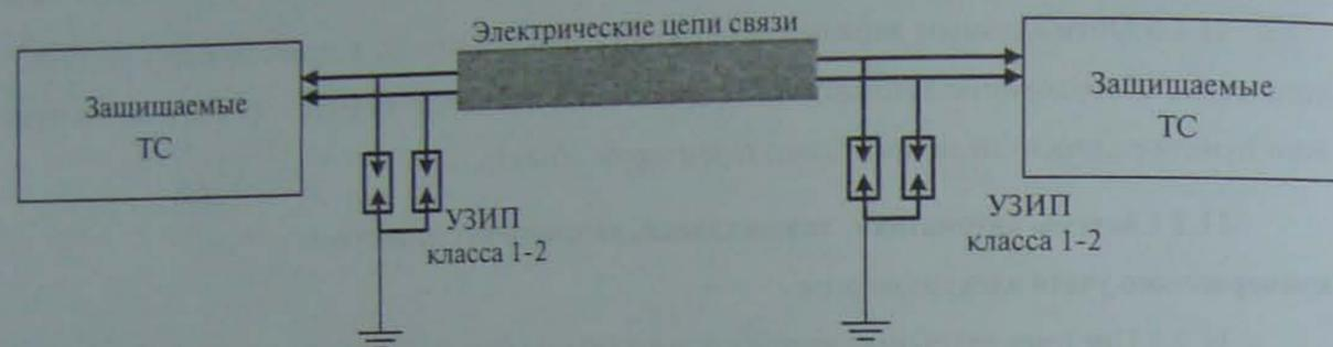
Рисунок 11.3 – Общая схема снижения помех в сигнальных цепях оборудования систем автоматики
