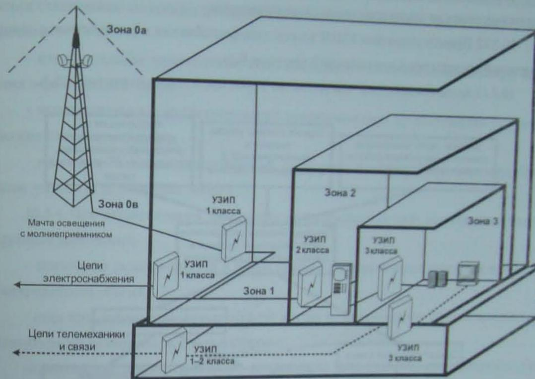
Рисунок 10.2 – Зоны молниезащиты согласно зонной концепции
