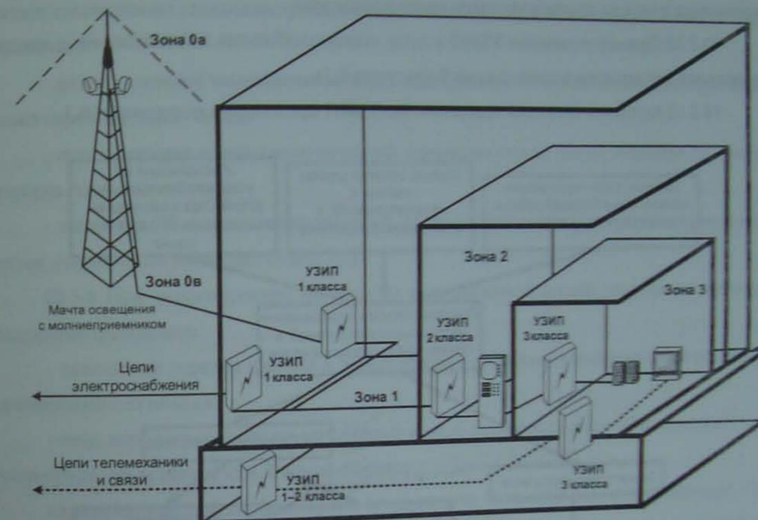
Рисунок 10.2 – Зоны молниезащиты согласно зонной концепции
