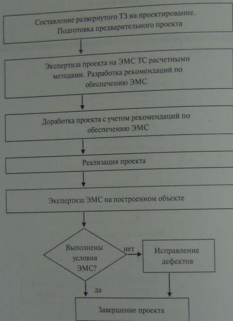
Рисунок А.2 – Алгоритм организации работ по обеспечению ЭМС ТС при строительстве нового объекта
