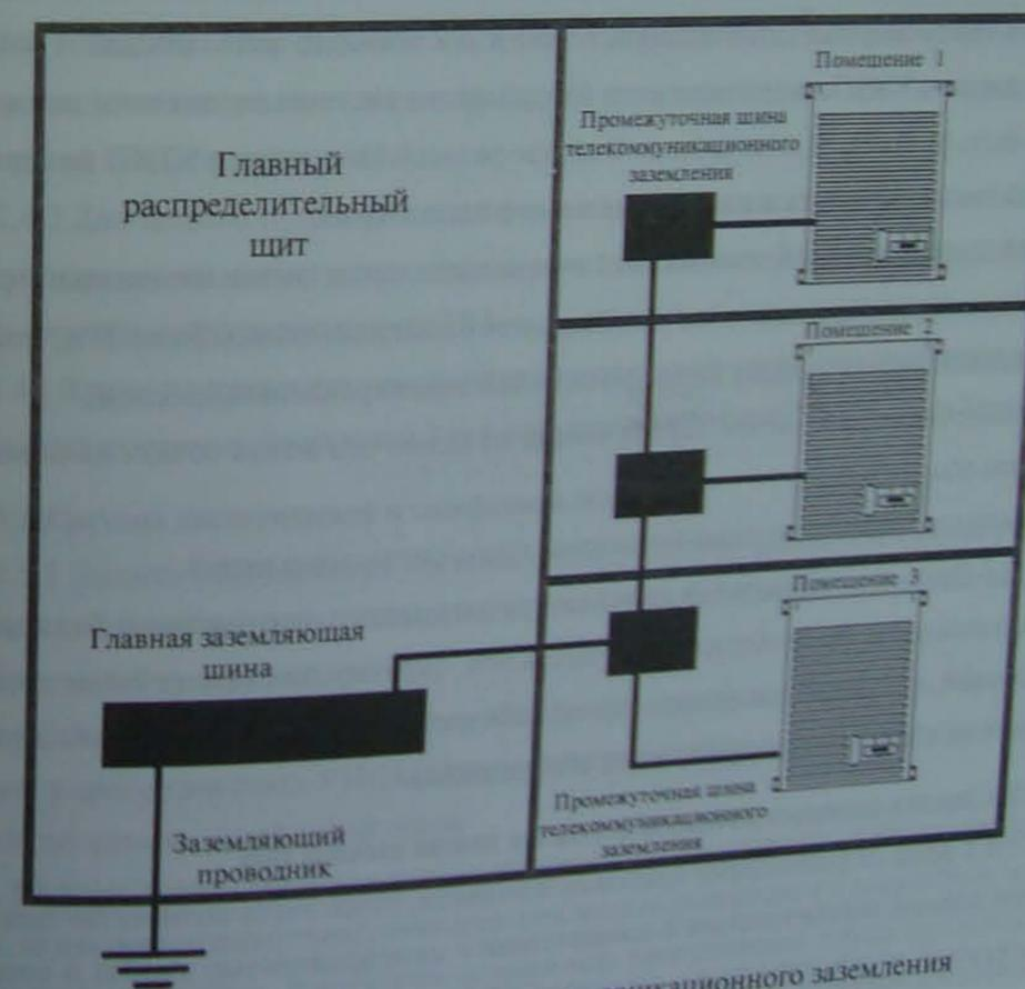
Рисунок 11.2 – Типовая схема телекоммуникационного заземления
