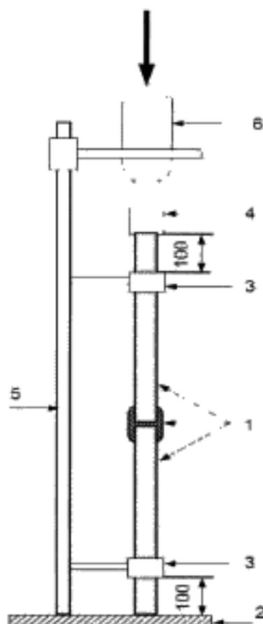
1 – образец; 2 – металлическая плита; 3 – подшипник; 4 – приводная головка;
