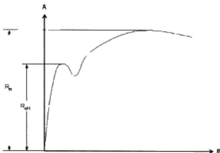
A – предел прочности при растяжении; B – удлинение
